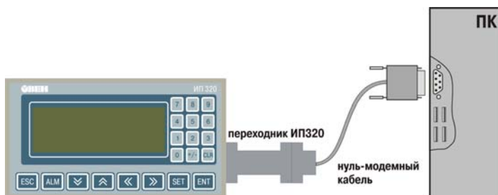
Рис. 5.1. Схема подключения интерфейса RS-232 (а) и интерфейса RS-485 (б) для конфигурирования панели ИП320
